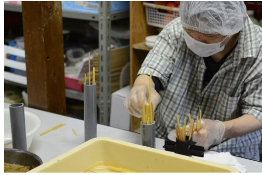
規格の長さの塩ビパイプにストローを入れる作業。カットするのは職員。
